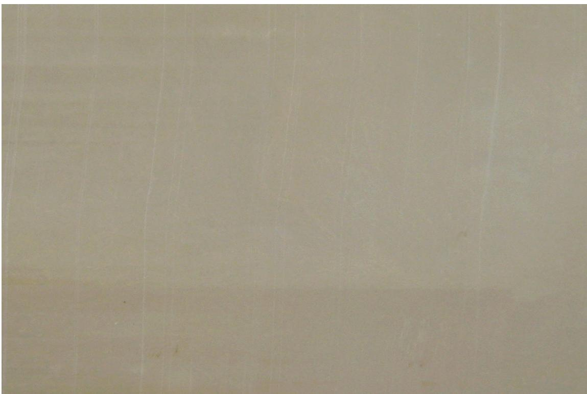
**DESCRIPCIÓN PETROGRÁFICA (UNE-EN 12407:2007)** Arenisca de tonalidad gris claro y homogéneo. Tamaño de grano fino. Se clasifica como litarenita, compuesta fundamentalmente por clastos carbonatados, y fragmentos de roca de origen volcánico y metamórfico. El cemento que cohesionan los granos es de naturaleza calcárea.
